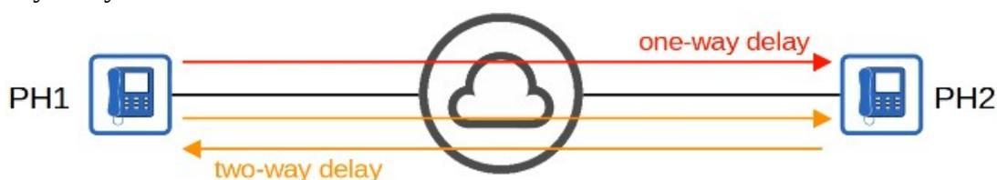
3. Jitter : est la variation du one-way delay entre le paquet envoyé par la même application. Les téléphones IP ont un « jitter buffer » pour fournir un délai fixe aux paquets audio.
